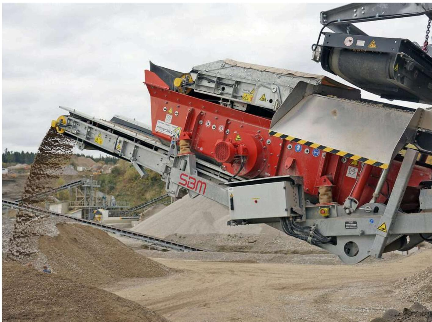
**Das optionale Eindeck-Nachsieb (1.300 x 3.700 mm) des REMAX 400 ist als Kreisschwingersieb mit elektrischem Doppelantrieb und bietet ein großes Haldenvolumen bis zu 160 Tonnen.**
