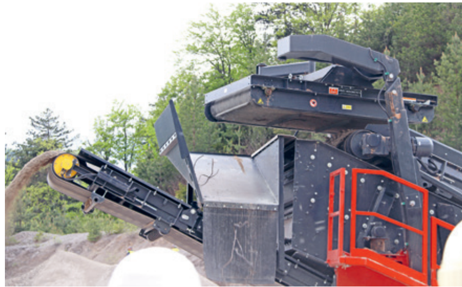
Der Überbandmagnet mit Längsaustrag über dem Hauptband reinigt besonders effizient und ist ein Alleinstellungsmerkmal in dieser Anlagenklasse.
