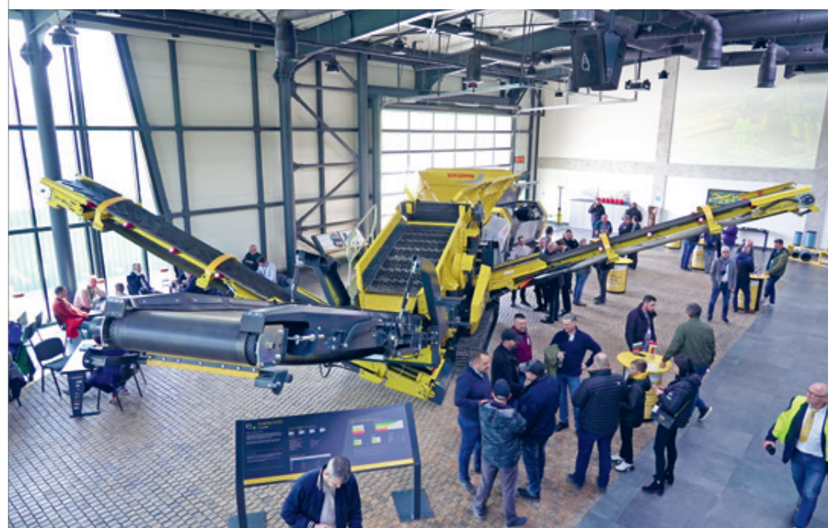
Interessante Facts: für die gesamte Produktpalette von Keestrack sind hybride und Plug-in-Diesel-/Elektroantriebsoptionen verfügbar, mit Drop-off-Motor und Zero-System. Im Bild der Prallbrecher R6.
