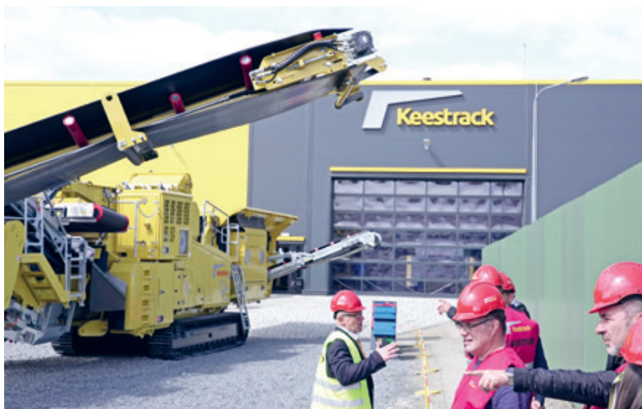
Interessante Facts: für die gesamte Produktpalette von Keestrack sind hybride und Plug-in-Diesel-/Elektroantriebsoptionen verfügbar, mit Drop-off-Motor und Zero-System. Im Bild der Prallbrecher R6.
