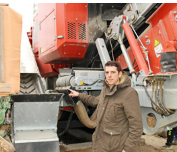
Lukas Schachner mit dem Windsichter für die Stör- und Leichtstoffaustragung am Überkornband der SBM Remax 450. Rechts: Dank Windsichter ist auch der aufbereitete Altasphalt frei von Störstoffen.
